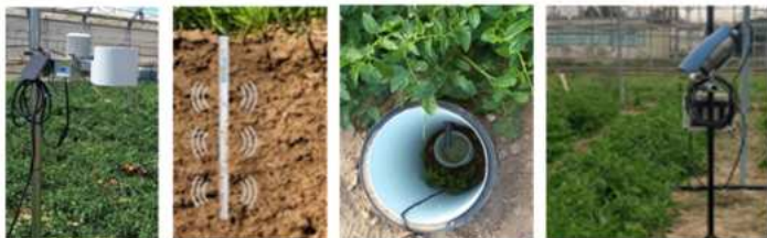
Figura 1. Parcela de ensayo experimental con control del ambiente, de suelo, de agua drenada y el cultivo en continuo y en tiempo real con activación del riego y la fertilización a través de telegestión.
